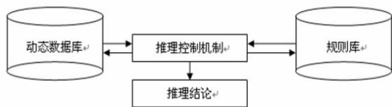
图 2 推理机工作原理示意图
